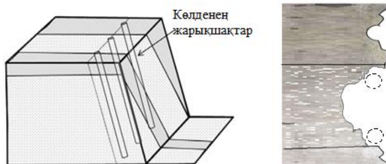
Сурет 15 - Зарядталған блок, аттырылған блоктың проекциялық қимасы Көлбеу және тік немесе вертикаль бағыттағы жарықшақтар кемердің құлау беткейінің теріс көрсеткіштеріне алып келсе, ал горизонталь бағытта таралған жарықшақтар қопсыманың теріс көрсеткіш деңгейін
